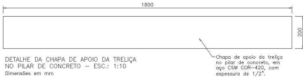
Figura 1.7 – Detalhe da chapa de apoio da treliça.
