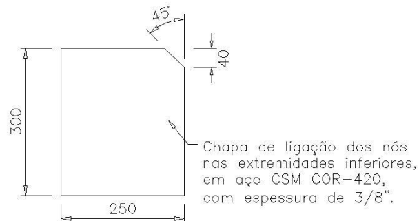
DETALHE DA CHAPA DE LIGAÇÃO DOS NÓS NAS EXTREMIDADES INFERIORES — ESC.: 1:10 Dimensões em mm
