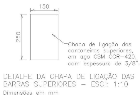
Figura 1.6 – Detalhe da chapa de ligação das barras superiores.
